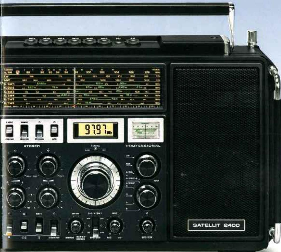
Echter Doppelsuper bei  $K_1 \dots K_4$  mit Vierkreisbandfilter für die 1. Zwischenfrequenz und Keramikfilter für die 2. ZF. Lückenloser Bereich von 187 bis 11 m mit 6 gespreizten Teilbereichen.
